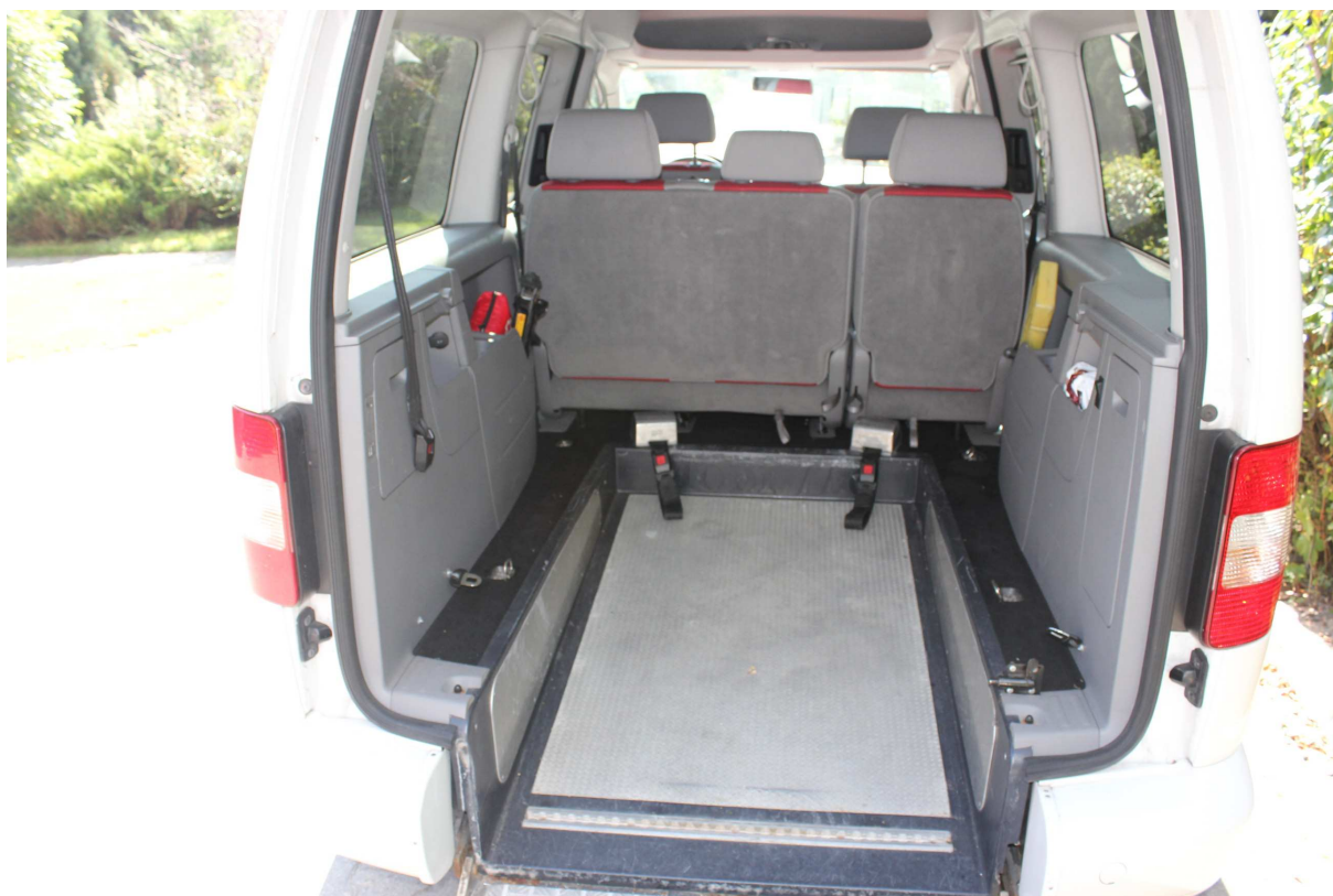
4. Widok wbudowanego miejsca MOBITEC do przewożenia osoby na wózku inwalidzkim /1 osoba na wózku/. Zgodnie z normą DIN 75078 /w tle 5 siedzeń/
