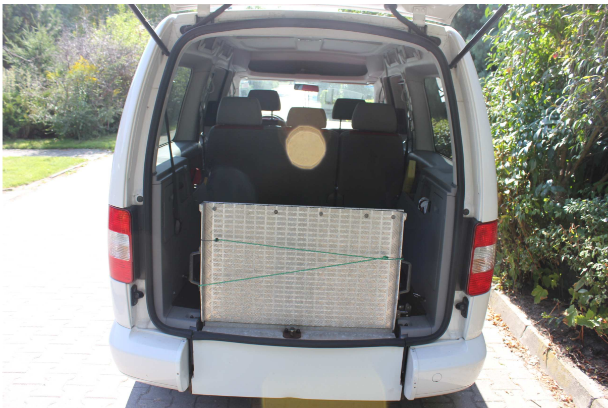
7. Widok rozkładanej ramy dla wjazdu wózka inwalidzkiego samochodu nr rej FG5636C
