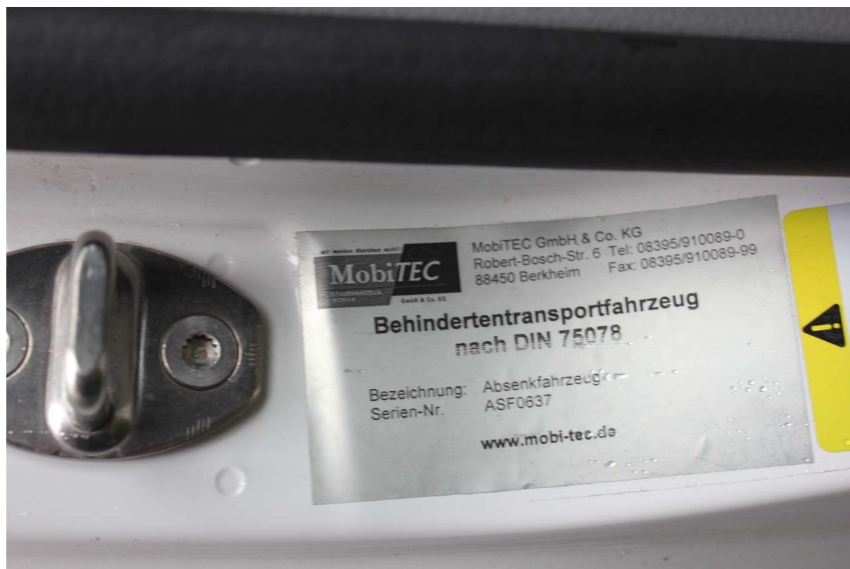
8. Naklejka potwierdzająca zamontowanie systemu MOBITEC do transportu osób niepełnosprawnych z systemem mocowania dla maksymalnie jednego wózka inwalidzkiego zgodnie z DIN 75078 o numerach seryjnych ASF 0637 w samochodzie VW Caddy nr rej FG5636C.
